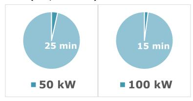
Die Ladeleistung muss sowohl fahrzeugseitig (Onboard Ladegerät) als auch von der Ladeinfrastruktur (Ladestation) unterstützt werden. Zu beachten ist insbesondere ob die Ladeleistung mit Gleichstrom (DC) oder Wechselstrom (AC) erreicht wird, sowie mit welcher Anzahl an Phasen.
